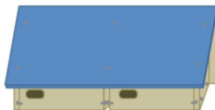
6. Die Schraubhaken so in die Wände schrauben, dass die Fronten nicht von alleine aufklappen können und das Dach auf den Wänden befestigen.
